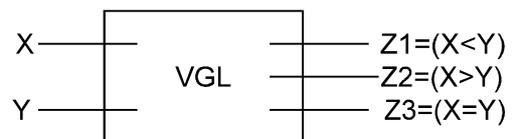
Dabei sind X und Y die beiden binären Ziffern. Die drei Ausgänge der Schaltung entsprechen den Aussagen  $(X < Y)$ ,  $(X > Y)$  und  $(X = Y)$ . Auch diese Vergleichsschaltungen können durch logische Operationen dargestellt werden:
